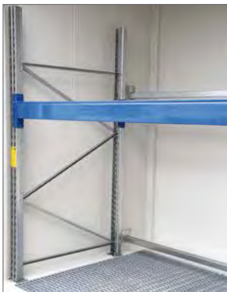
1er niveau de stockage sur caillebotis, 2ème niveau de stockage sur traverse avec butée de chargement
